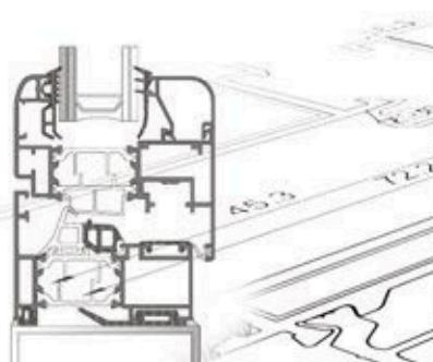
Oltre alla soluzione tradizionale a sormonto e camera europea è possibile realizzare tipologie complanari e tipologie con ferramenta a nastro.
