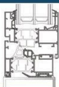
■ sistema MA72hp permette l'inserimento di vetri altamente fonoisolanti, blindati, con veneziane interne etc.
