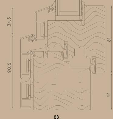
**MAWOODART HP** (hight performance) nasce dall'evoluzione del sistema MAWOODART per offrire un prodotto più performante dal punto di vista termico semplicemente aumentando la sezione delle cornici di legno. Il sistema permette la costruzione di finestre e portefinestre a 1 o più ante, wasistas, antaribalta, portoncini, moduli fissi, scorrevoli paralleli, soluzioni con soglia ribassata di soli 22 mm, profili standard e maggiorati.
